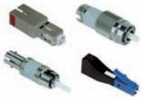
Les atténuateurs fixes sont souvent utilisés pour niveler la puissance dans les transmissions optiques. Ils sont destinés à empêcher que trop de lumière arrive sur les récepteurs parfois sensibles au niveau de puissance et qui pourrait les endommager. Faciles à manipuler, les atténuateurs, de type Plug-in, sont également très appréciés dans des laboratoires pour les applications de recherche.
