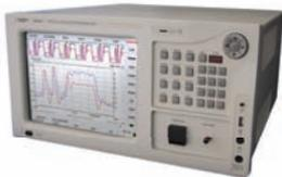
La série des AP2440 possède les mêmes spécificités et les mêmes fonctions que la série des AP2040 mais permet en plus une mesure de phase et la caractérisation du signal dans le domaine temporel: variations impulsionnelles, chirp, variations de phase, constellations, diagramme de l'oeil en phase ou en intensité...
